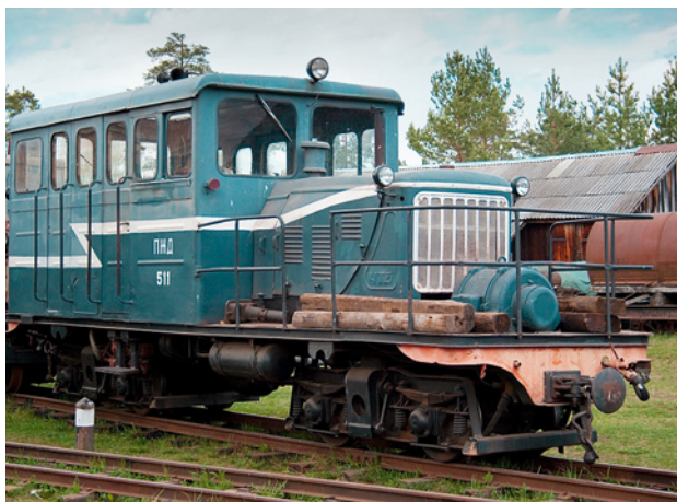
Четырехосный мотовоз — самоходная электростанция ЭСУ2а-511 Губинского механического завода
